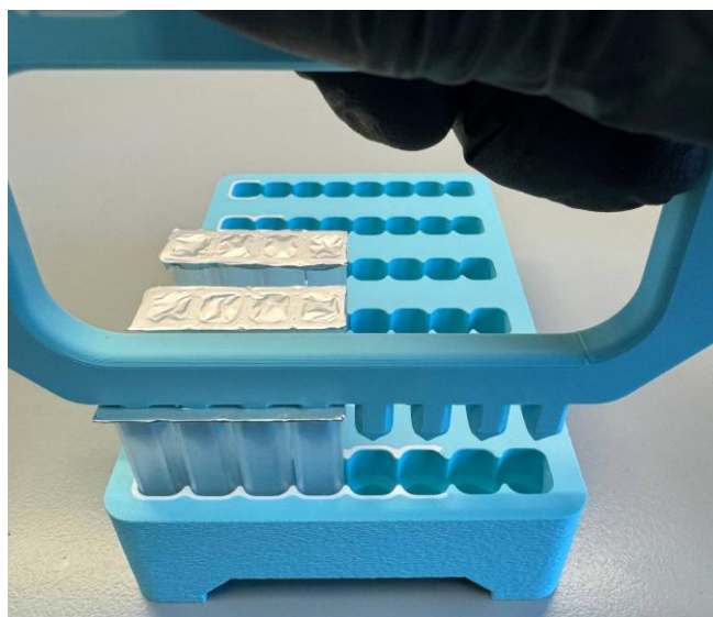
Рисунок 1 – Прокалывание защитного слоя стрипов
