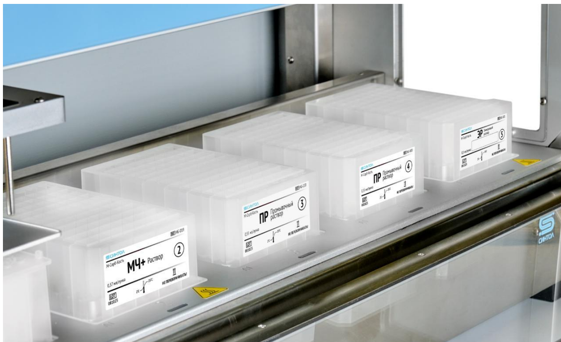
Рисунок 10 – Расстановка планшетов в автоматической станции «COLIBRI 96»
