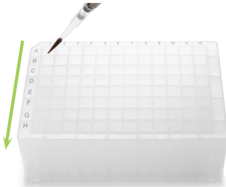
Рисунок 8 – Порядок внесения супернатанта в лунки планшета с Раствором МЧ+
