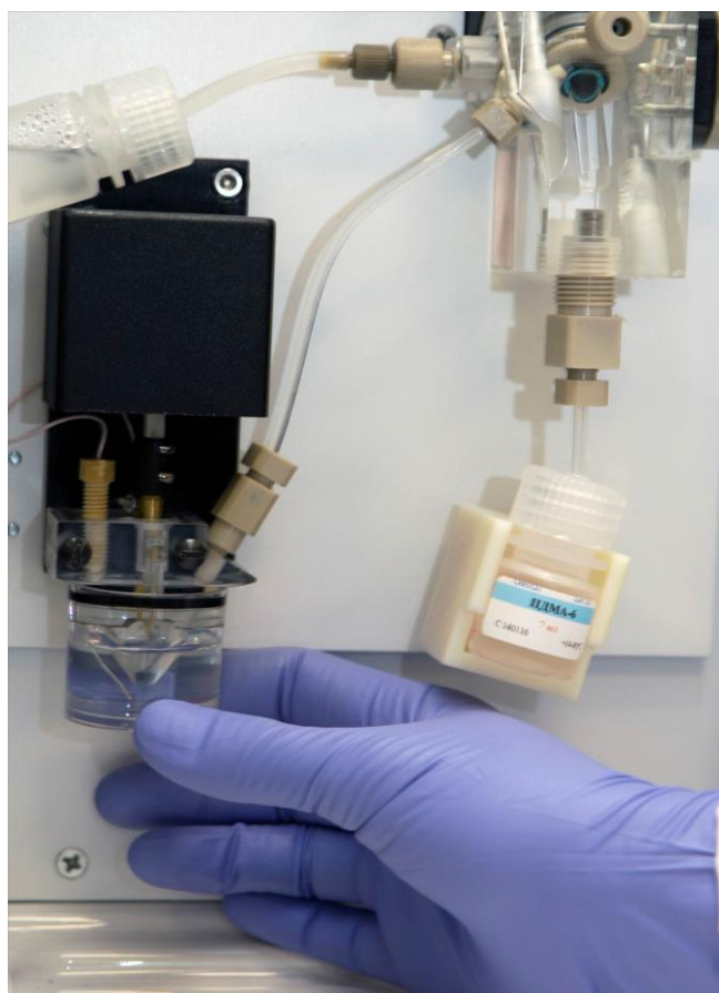
Рисунок 24. Замена анодного буфера
