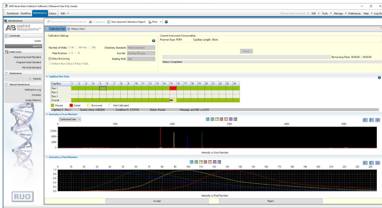
Рисунок 11 – результат успешной калибровки генетического анализатора GA3500xL с помощью спектрального калибратора «GenSeqMS».
