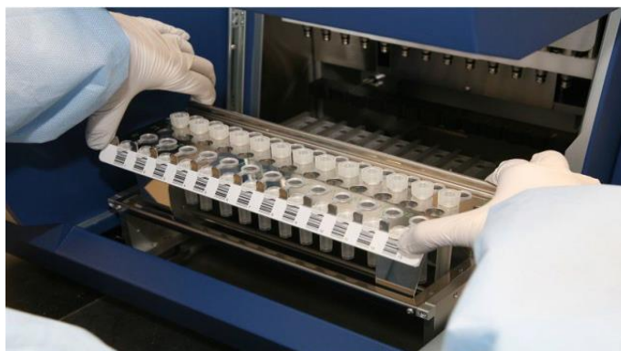
Рисунок 2 – Установка штатива с пробирками и наконечниками в автоматическую станцию
