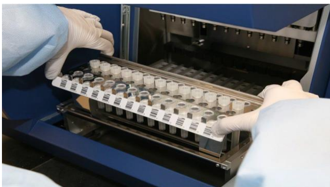
Рисунок 14 – Установка штатива с пробирками и наконечниками в автоматическую станцию
