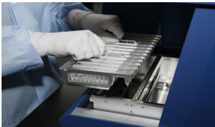
Рисунок 7 – Установка держателя с помещенными в него картриджами с реагентами «M-Corb AutoMate Express» в автоматическую станцию
