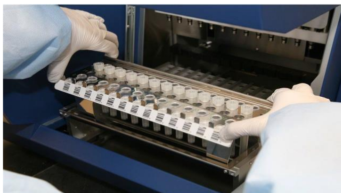
Рисунок 6 – Установка штатива с пробирками и наконечниками в автоматическую станцию
