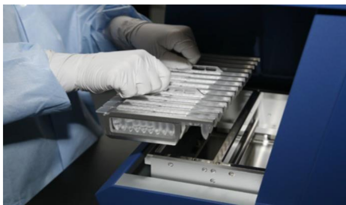
Рисунок 5 – Установка держателя с помещенными в него картриджами с реагентами «М-Сорб AutoMate Express» в автоматическую станцию
