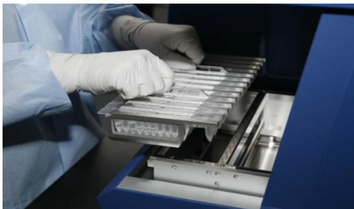
Рисунок 13 – Установка держателя с помещенными в него картриджами с реагентами «М-Сорб AutoMate Express» в автоматическую станцию
