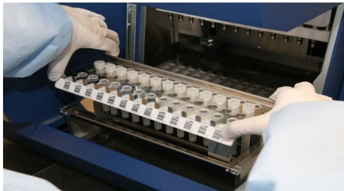
Рисунок 8 – Установка штатива с пробирками и наконечниками в автоматическую станцию
