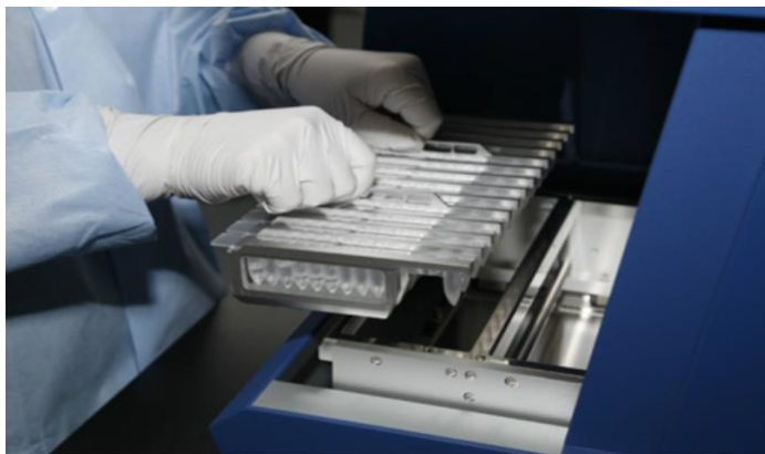
Рисунок 15 – Установка держателя с помещенными в него картриджами с реагентами «М-Corб AutoMate Express» в автоматическую станцию
