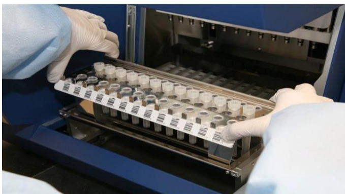
Рисунок 4 – Установка штатива с пробирками и наконечниками в автоматическую станцию
