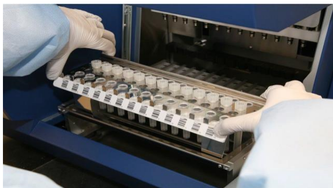
Рисунок 10 – Установка штатива с пробирками и наконечниками в автоматическую станцию
