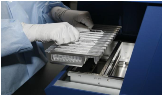
Рисунок 9 – Установка держателя с помещенными в него картриджами с реагентами «М-Сорб AutoMate Express» в автоматическую станцию
