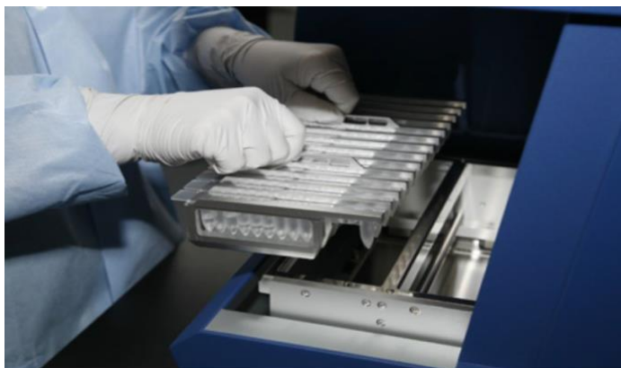
Рисунок 3 – Установка держателя с помещенными в него картриджами с реагентами «M-Corб AutoMate Express» в автоматическую станцию
