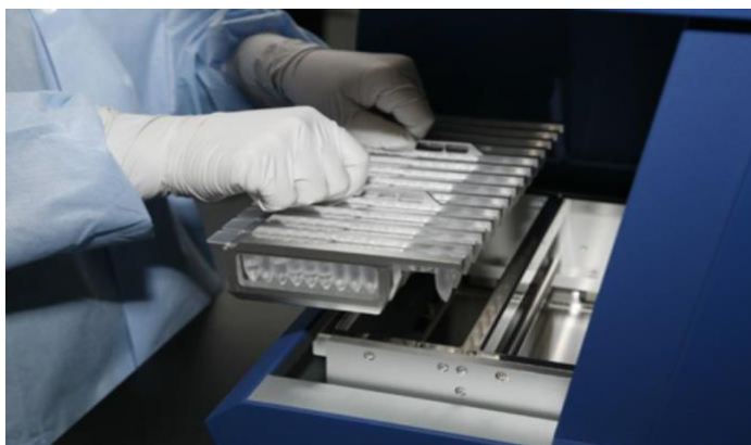
Рисунок 11 – Установка держателя с помещенными в него картриджами с реагентами «M-Corб AutoMate Express» в автоматическую станцию
