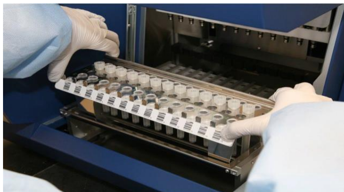
Рисунок 12 – Установка штатива с пробирками и наконечниками в автоматическую станцию
