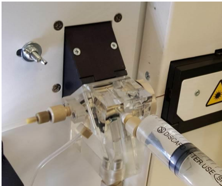
Рисунок 9. Промывка водной ловушки насос
