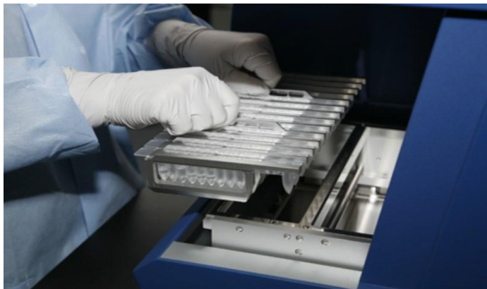
Рисунок 1 - Установка держателя с помещенными в него картриджами с реагентами «М-Сорб-Кость AutoMate Express» в автоматическую станцию
