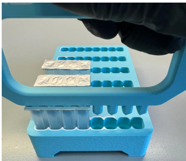
Рисунок 1 – Прокалывание защитного слоя стрипов
