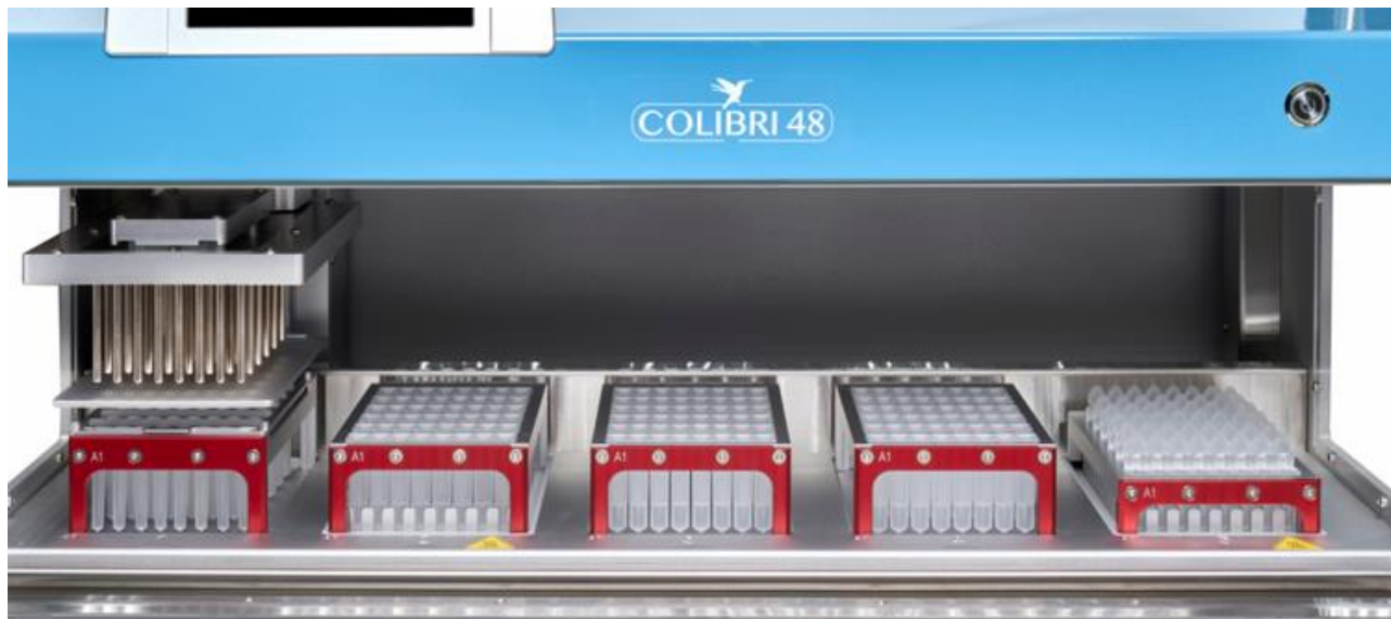
Рисунок 4 – Расстановка штативов со стрипами в автоматической станции «COLIBRI 48»
