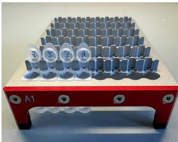
Рисунок 7 – Установка стрипов с Элюирующим раствором ЭР в штатив для пробирок для элюции «COLIBRI 48»
