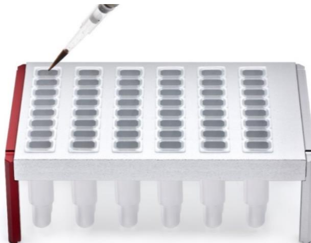
Рисунок 2 – Порядок установки стрипов в штатив и внесения образцов в пробирки стрипа
